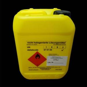
A yellow plastic jerrycan with a black handle and a label that reads 'nicht halogenierte Lösungsmittel' and 'Abfallcode 19 03 01'. | <p><b>Gelbe Kanister</b></p> <p><b>nicht halogenierte Lösungsmittel (chlorfrei)</b></p> <p>z. B. Aceton, Ethanol, Ether, Hexan, Methanol, Toluol, Xylol, Alkohole, Petrol, Petrolether etc.<br/>Gemische aus nicht halogenierten Lösungsmittel</p> <p><b>Wichtig: Abgabe nur mit seitlich angebrachter Adressetikette</b></p>                                   |
