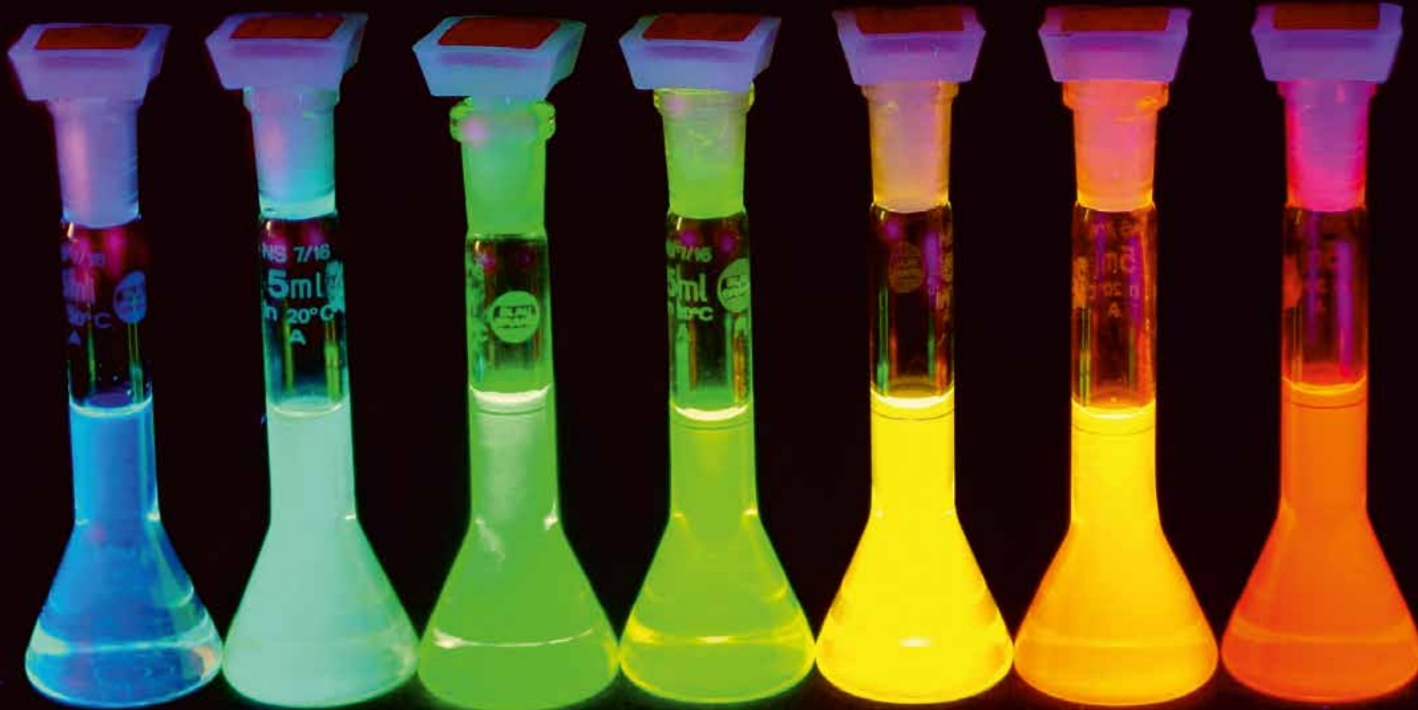
Bild: Die Lumineszenz von kolloidalen CdSe/ZnS-Nanopartikeln ist abhängig von der Partikelgrösse (links: ~2nm, rechts: ~6nm) © 2022 Dmitri V. Talapin
