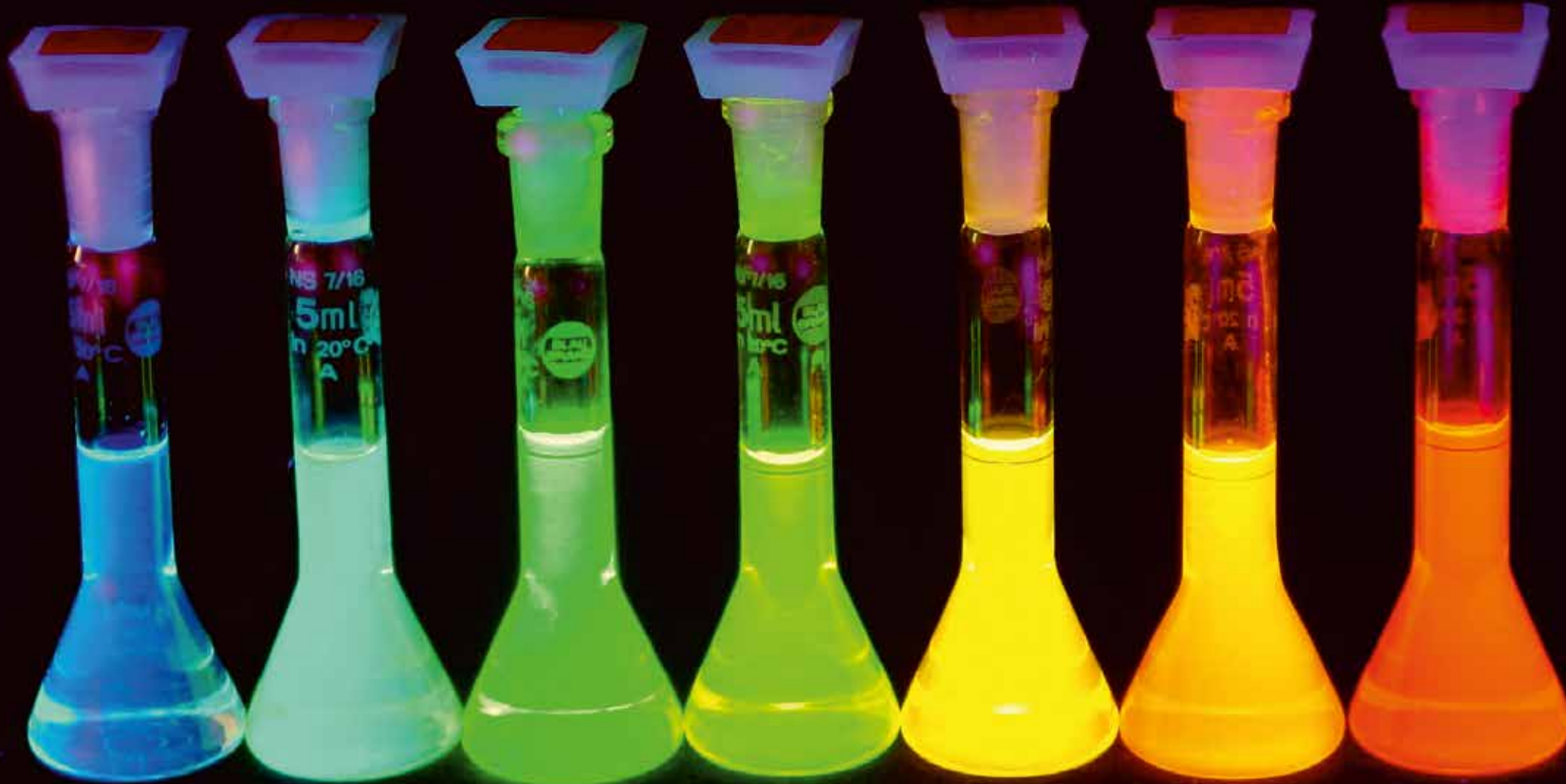
Bild: Die Lumineszenz von kolloidalen CdSe/ZnS-Nanopartikeln ist abhängig von der Partikelgröße (links: ~2nm, rechts: ~6nm) © 2016 Dmitri V. Talapin
