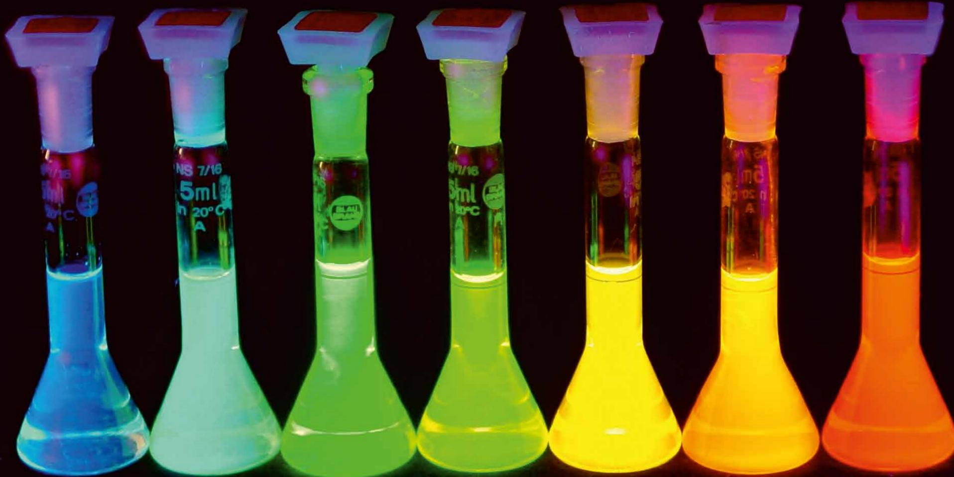
Bild: Die Lumineszenz von kolloidalen CdSe/ZnS-Nanopartikeln ist abhängig von der Partikelgröße (links: ~2nm, rechts: ~6nm) © 2019 Dmitri V. Talapin
