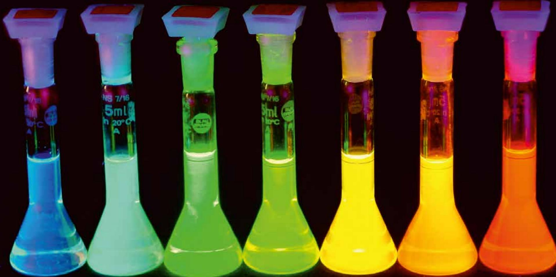
Bild: Die Lumineszenz von kolloidalen CdSe/ZnS-Nanopartikeln ist abhängig von der Partikelgrösse (links: ~2nm, rechts: ~6nm) © 2021 Dmitri V. Talapin
